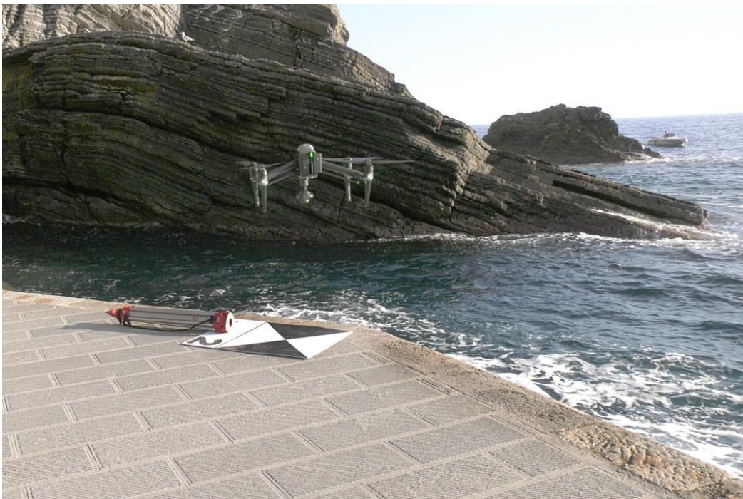
Foto 2: Un momento dei rilievi aerofotogrammetrici con drone per la realizzazione delle mappe di rischio costiero ad altissima risoluzione
